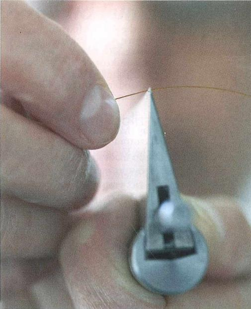
**Abb. 8:** Haartest zur Überprüfung der Schärfe eines Mikrotom-Messers.
