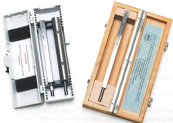
**Abb. 9:** Mikrotom-Messer in einer Holz- und Kunststoffbox.
