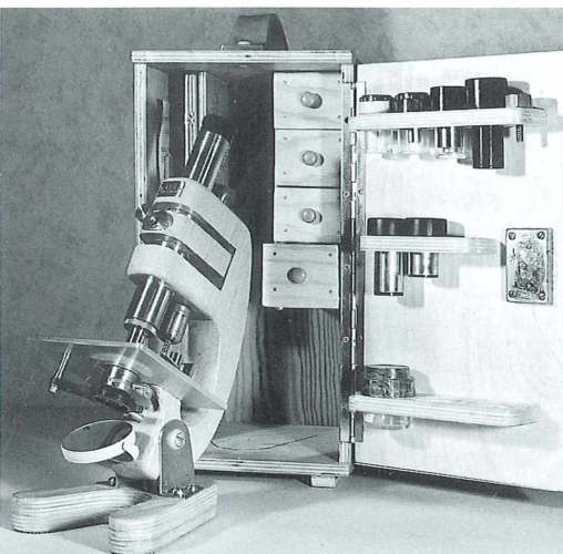
Abb. 5: Das Selbstbaumikroskop mit Zubehör wird im Schränkchen auch für Exkursionen gut transportfähig.
