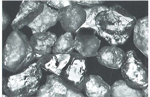
Abb. 1: Quarzkörner im polarisierten Licht. Vergr. 10fach.
