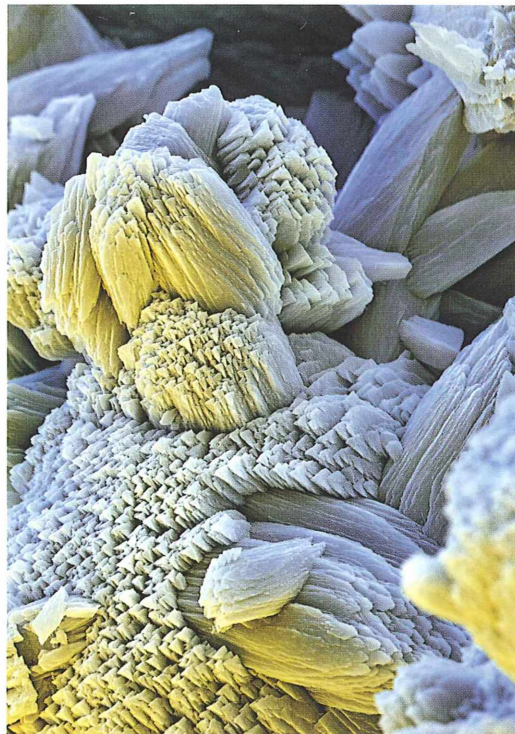
Abb. 6: Kesselstein (Calciumcarbonat) aus einem Würzburger Wasserkessel; Bildfeldgröße 46 \times 90 \mu\text{m} . Zweikanalige REM-Aufnahme, selektive Farb- und Kontraständerungen in Photoshop.
