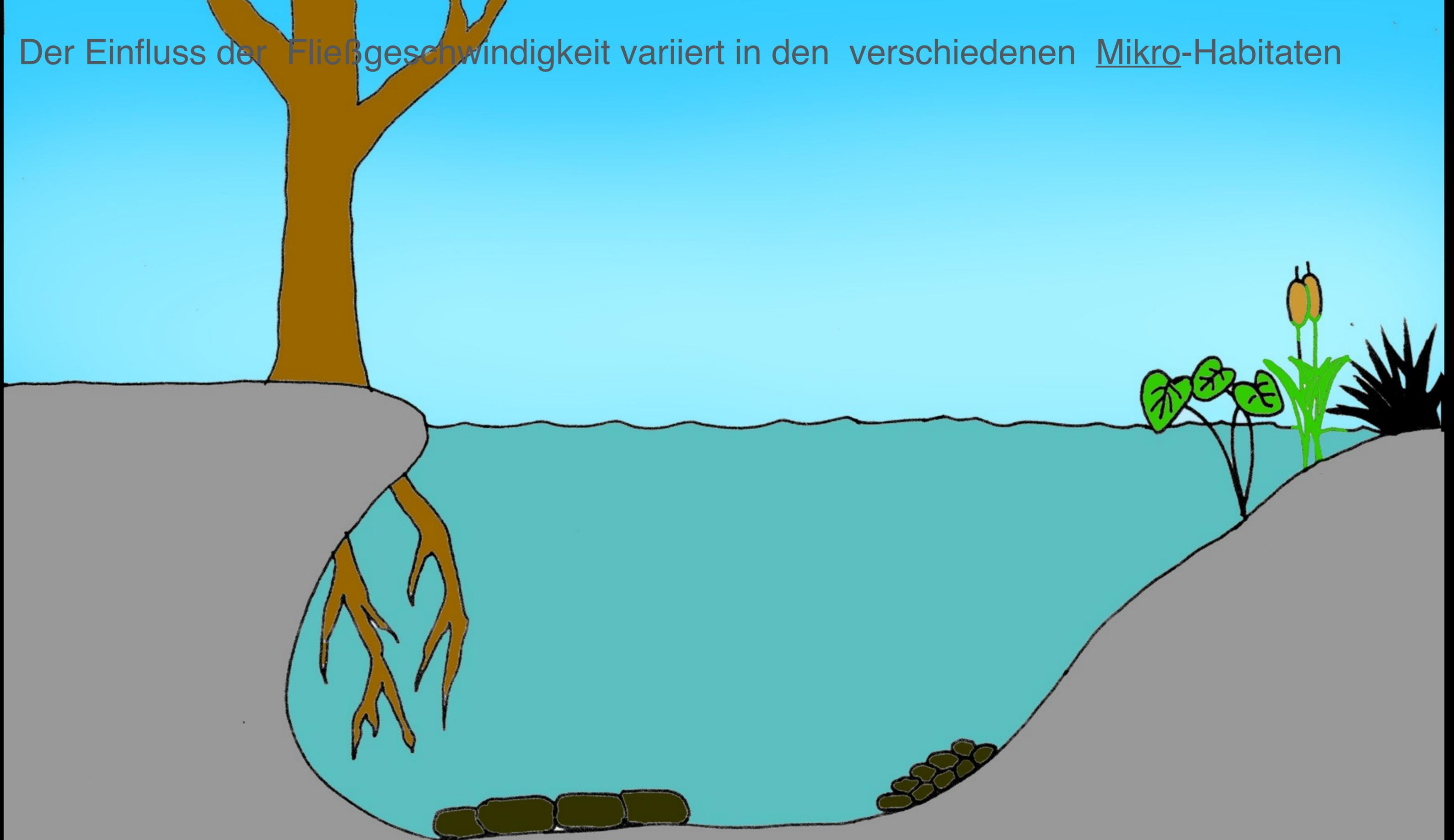
Im Bereich von Grenzflächen ist die Fließgeschwindigkeit sehr gering: Laminare Strömung
