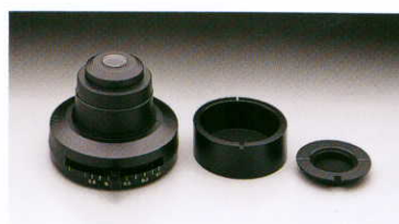
CH3-CDP Polarisationskondensator Mit diesem Abbé-Kondensator ist einfache Polarisation von 4x bis 100x möglich. Ein zusätzlicher Polarisator (U-POT) wird auf die Leuchtfeldblende am Mikroskopstativ gelegt, ein Analysator (U-ANT) wird in die Aufnahme am Mikroskopstativ eingelegt.
