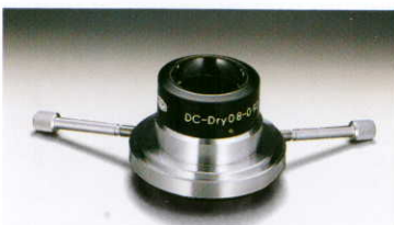
BH-DCD Trocken-Dunkelfeld-Kondensator Scharfe Dunkelfeldbilder können mit diesem Trockenkondensator erzielt werden, bei dem keine Ölimmersion notwendig ist. Die numerische Apertur von 0.8/0.92 paßt zu den Objektiven 10x, 20x und 40x mit einer N.A. bis zu 0.65.
